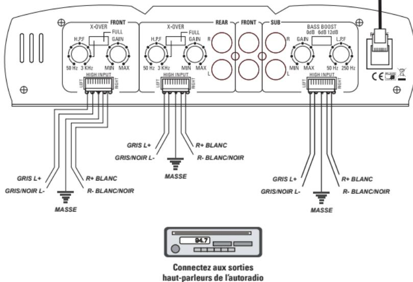
Les entrées haut niveau ne doivent être utilisées que lorsque votre autoradio ne dispose pas de sorties RCA. Connectez les sorties haut-parleur au connecteur d'entrée haut niveau de l'amplificateur. Assurez-vous d'observer les polarisés pour éviter les problèmes de phase. Le fil de masse peut-être connecté à la masse de l'autoradio.
