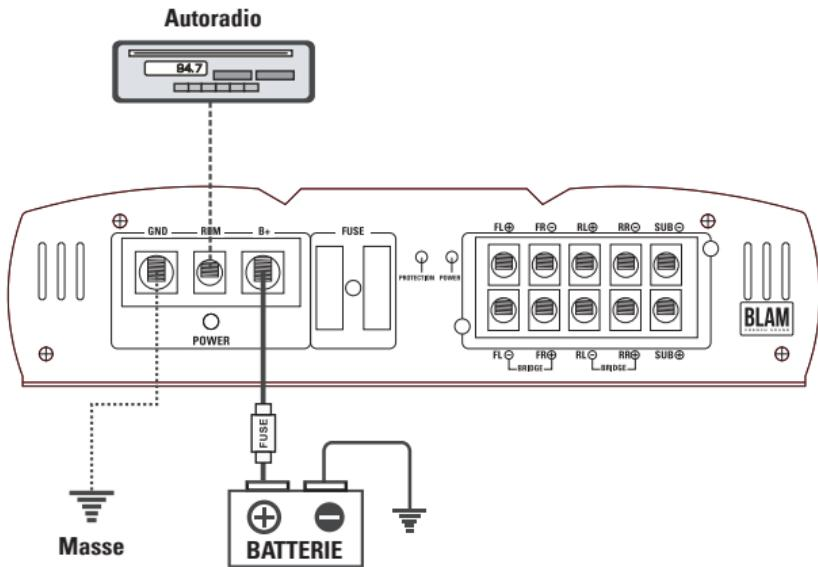
Connection à la batterie (+12 Volts) : Connectez un câble de 8mm<sup>2</sup> minimum avec un porte-fusible placé à moins de 45 cm de la batterie de la voiture et reliez le à la connexion "BATT +".
